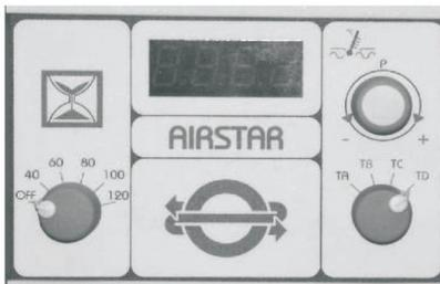
Mit einem zweiten Drehschalter kann die Reiztemperatur eingestellt werden. Zur Auswahl stehen: 4 frei programmierbare Temperatureinstellungen (TA, TB, TC und TD) für Temperatureinstellungen von z.B. 20 °C, 27 °C, 30 °C und 44 °C.
